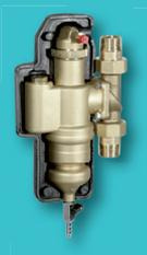
Braukmann HF49 combina in un'unica unità un defangatore, un disaeratore e una valvola di sfiato che, con il principio della forza centrifuga, eliminano lo sporco e le particelle di fango causa di guasti e danni agli impianti di riscaldamento. Cartuccia ai fosfati disponibile come accessorio.
