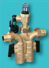
Vengono usati per proteggere gli impianti pressurizzati di riscaldamento dell'acqua. Integrano tutti i dispositivi di sicurezza necessari, come valvole di ritegno, rubinetti d'intercettazione e valvole di sicurezza di massima pressione. Su richiesta sono disponibili anche modelli con una valvola di riduzione della pressione installata a monte.
