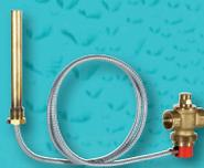
Braukmann TS131 è una valvola di sicurezza auto-azionata dalla temperatura del fluido del generatore di calore, o della batteria di condensazione, quando raggiunge i 95°C: la valvola si apre e scarica acqua prevenendo così un aumento eccessivo della temperatura interna. Conforme alla direttiva 2014/68/EU
