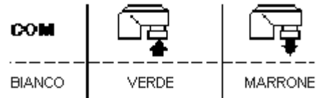
Colore dei cavi per attuatori a 24V (M6410C, M7410C)
